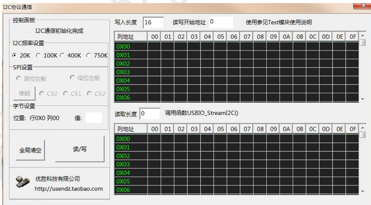
图 5: 电脑端 USB 转 IIC 软件图
